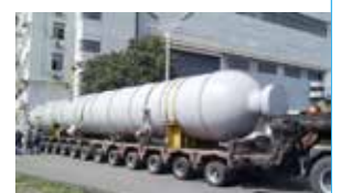
石家庄炼化循环氢脱硫塔
